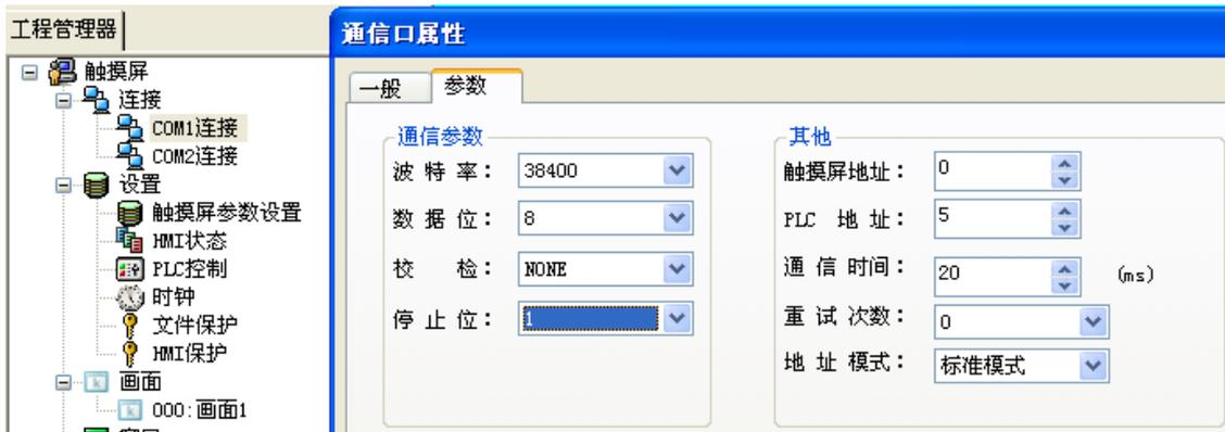
图 10 触摸屏端通讯参数设置
