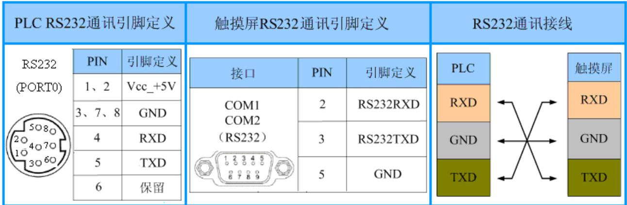
图 24 信捷触摸屏（TH765-N）RS232 通讯示意图
