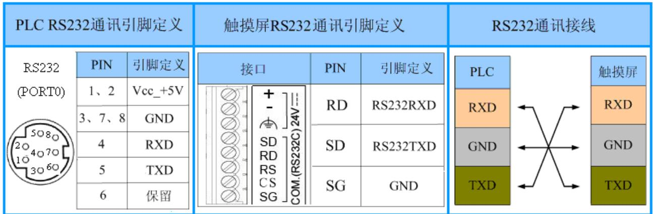
图 27 松下 GT32 (AIG32TQ02D) RS232 通讯示意图
