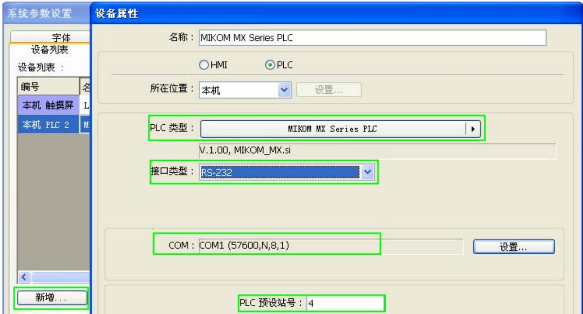
图 5 RS232 通讯触摸屏端参数设置
