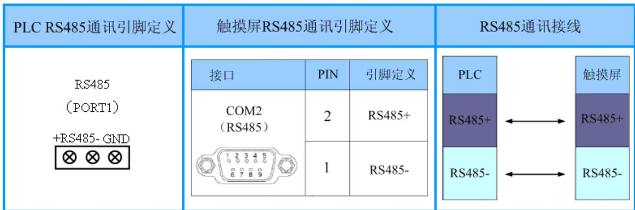
图 1 威纶通触摸屏 RS485 通讯示意图
