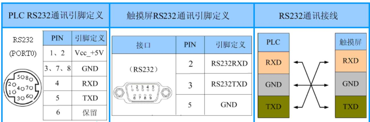
图 8 显控触摸屏 (SA-7B) RS232 通讯示意图
