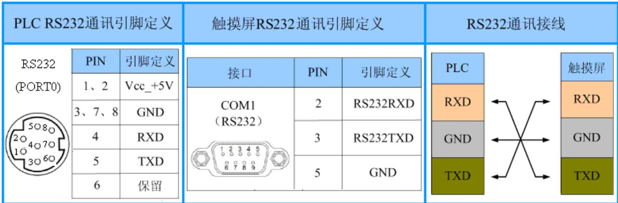
图 16 昆仑通态触摸屏 RS232 通讯示意图
