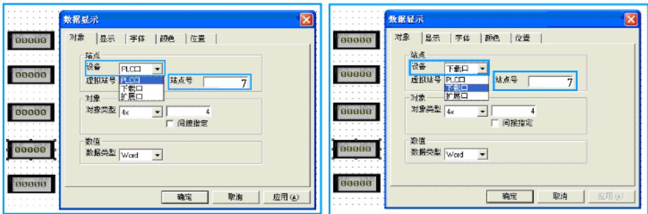
图 25 RS232 通讯触摸屏端通讯站号设置
