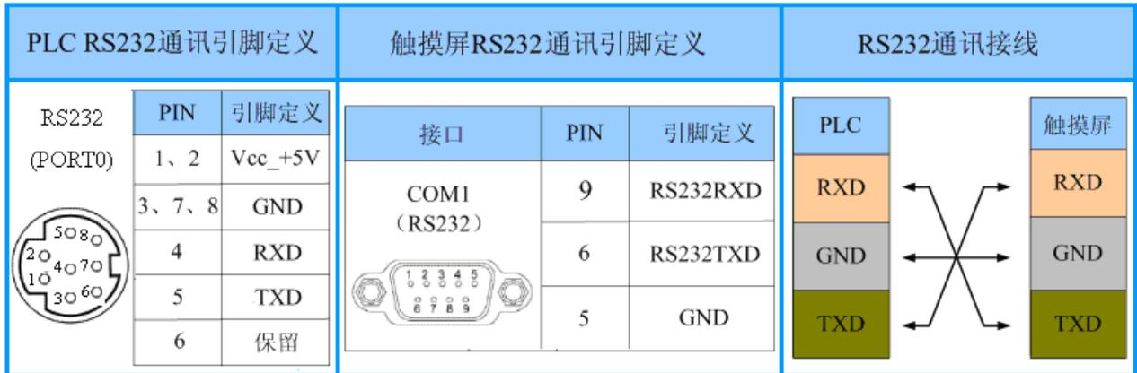
图 4 威纶通触摸屏 RS232 通讯示意图
