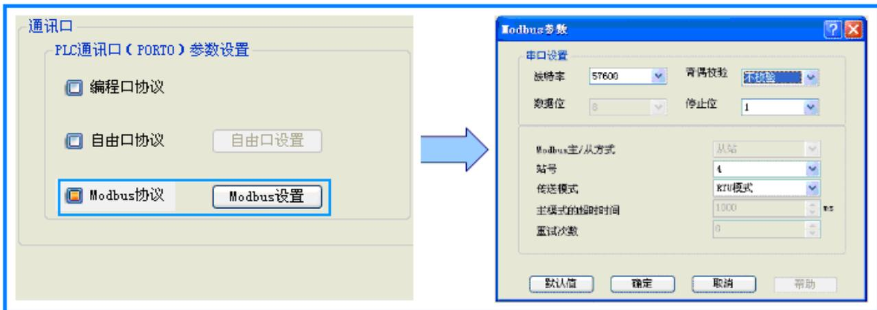
图 6 RS232 通讯 PLC 端通讯参数设置
