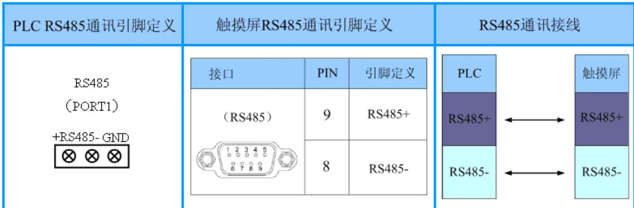
图 7 显控触摸屏 (SA-7B) RS485 通讯示意图
