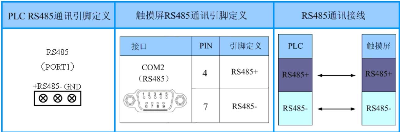
图 20 信捷触摸屏（TH765-N）RS485 通讯示意图
