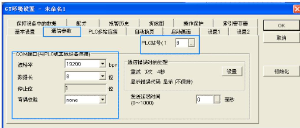
图 29 松下触摸屏 GT32 (AIG32TQ02D) 通讯参数设置
