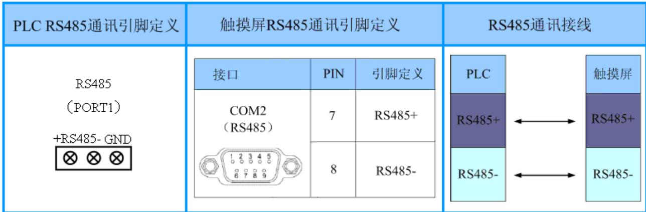
图 12 昆仑通态触摸屏 RS485 通讯示意图
