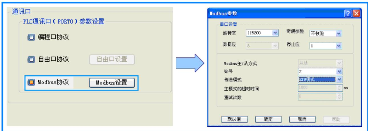
图 19 RS232 通讯 PLC 端通讯参数设置
